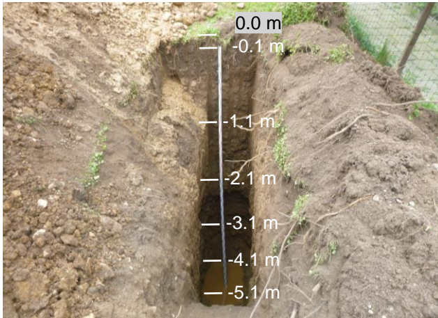
BS1 auf Endsondierentiefe mit Grundwasser bei 4.8 m
